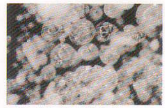
シラスバルーン(※2)顕微鏡写真 ※シラスバルーンとは上記火山性鉱物の微粉末を熱処理し、粒子を発泡させたもの。この微細な風船状の空洞が熱を伝えにくい性質に優れています。
